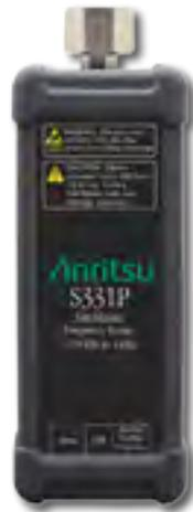
**ANRITSU SITE MASTER ULTRAPORTABLE CABLE AND ANTENNA ANALYZER**
